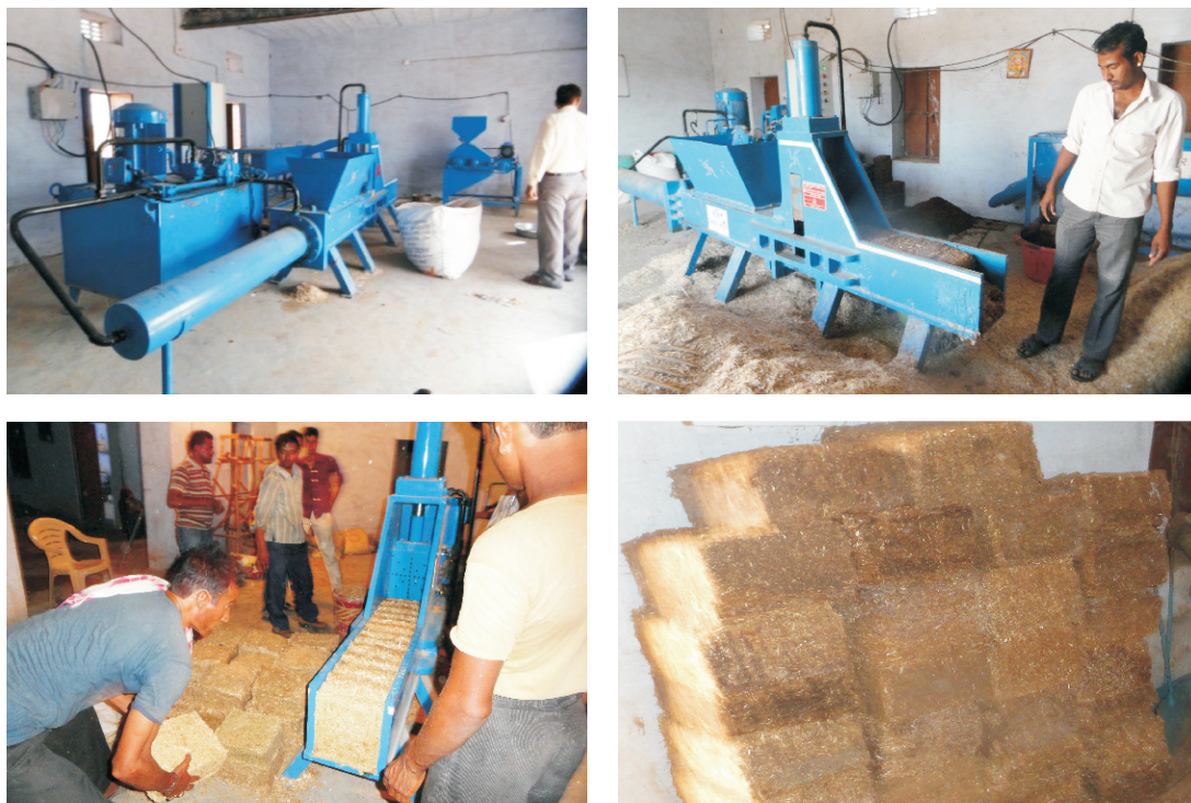
चित्र 16 नागौर जिले के हरसोलाव गांव में स्थापित सम्पूर्ण पशु आहार बट्टिका बनाने की मशीनें
