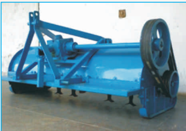
चोपर/मल्वर (सिंगल सिलेंडर) द्वारा पराली को कुतरा करके खेत में बिखेरना
