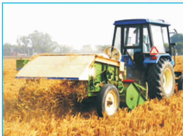
कंबाईन हैडर टाईप चोपर/मल्वर (डबल सिलेंडर) द्वारा पराली को कुतरा करके खेत में बिखेरना
