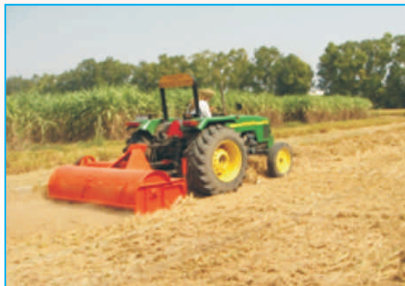
चोपर/मल्वर (सिंगल सिलेंडर) द्वारा पराली को कुतरा करके खेत में बिखेरना
