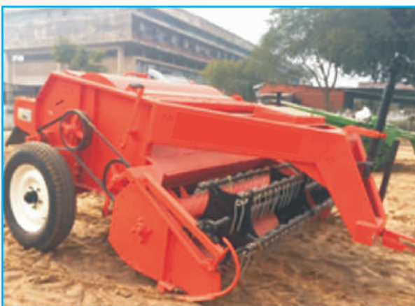
कंबाईन हैडर टाईप चोपर/मल्वर (डबल सिलेंडर) द्वारा पराली को कुतरा करके खेत में बिखेरना
